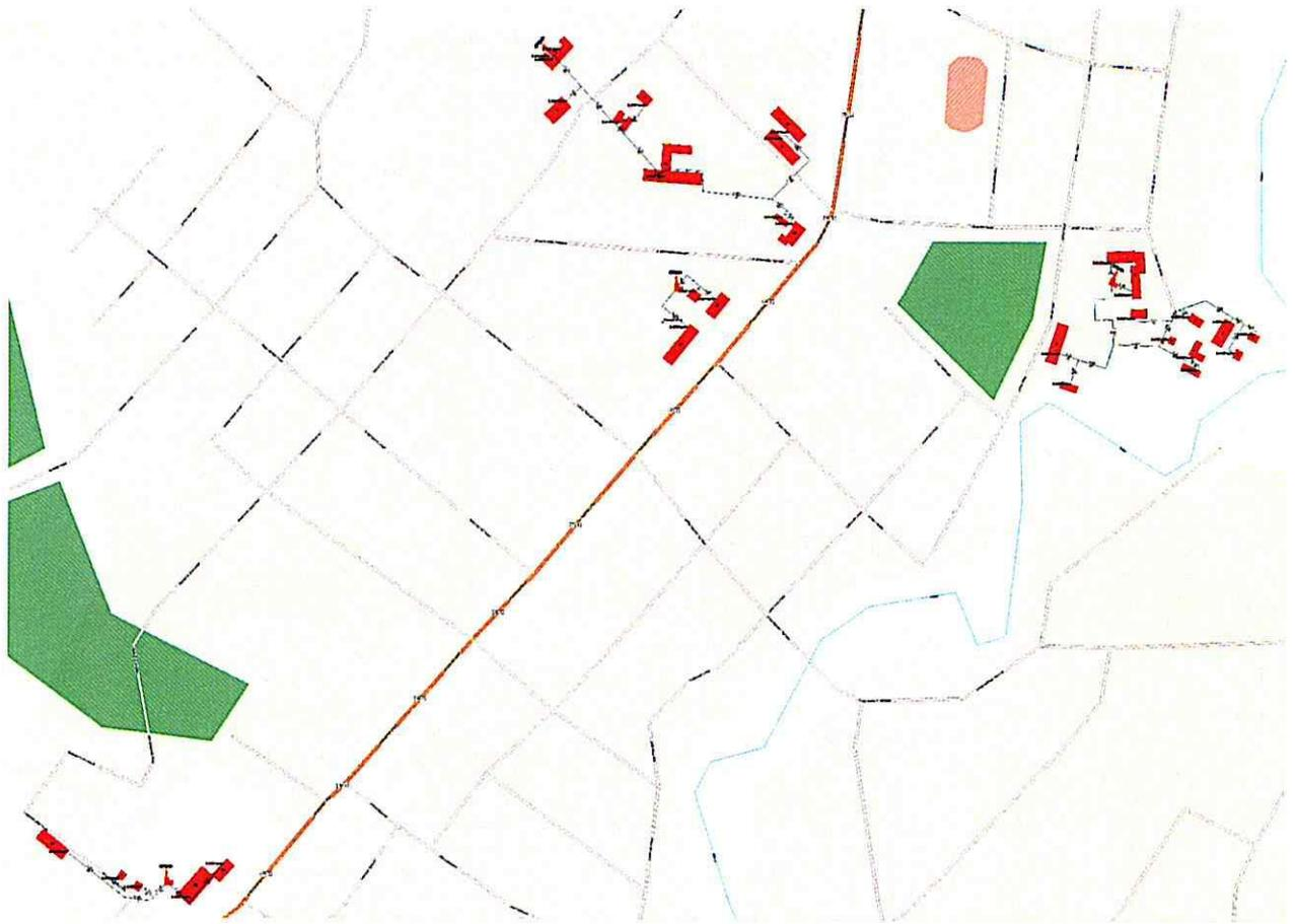
**Рис. 6 Тепловые сети и тепловые нагрузки на расчетный период**
